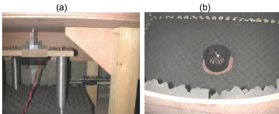
Figure 7 : Photographies du dispositif expérimental. (a) Partie « moteur » et microphone fixe placé sur la droite. (b) Ventilateur déporté dans la cabine acoustique.
